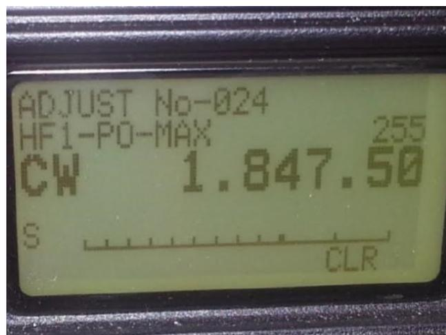
leggerete e che sono presenti in tutti i passi di programma in cui si andrà, sono quelli impostati **UNIVOCAMENTE APPARATO PER APPARATO, e quindi DIVERSI TRA UN APPARATO E L'ALTRO**. Scriverli vi servirà a riportare l'rtrx ai propri valori, una volta terminata la sperimentazione. OM avvisato, OM mezzo salvato!
