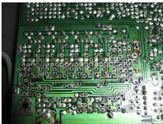
subito la colla e vi posso assicurare che è difficile da eliminare anche usando dei solventi. Puliti i componenti da quanta più colla possibile, si iniziano a dissaldare diodi, transistori, condensatori le resistenze le induttanze quelli coperti dalla colla, fino a lasciare solo la scheda con i fori Fig. 3. Nelle fig. 4, 5, 6 e 7 vi mostro la colla ancora attaccata ai componenti. Alcuni di essi generavano calore tanto che alcuni punti
