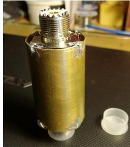
o in meno non crea problemi gravi. Sul cilindro esterno in modo diametralmente opposto, si praticano due coppie di fori, sui quali salderemo quattro dadi di ottone, entro i quali inseriremo forzatamente la parte interna di un cavo coax TV in modo che il link interno sia perfettamente isolato dalla carcassa, e si mantenga ad una distanza di circa 2 mm dalla superficie interna. Il disegno potrà chiarirvi eventuali dubbi sulla di-
