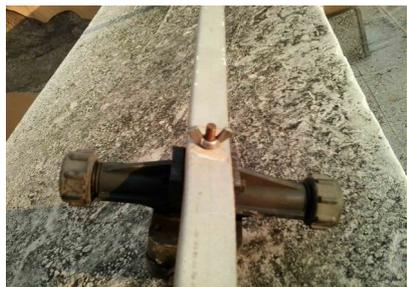
La seconda modifica consiste nell'aver sostituito i dadi di fissaggio dei supporti di tutti gli steli , radiatore e gamma match compreso , con dei più appropriati e veloci " galletti " .
