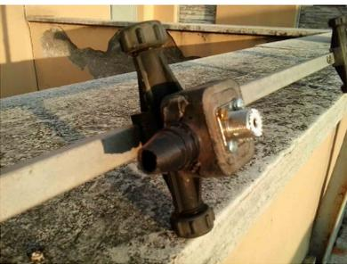
La prima modifica ha riguardato la connessione cavo-antenna che in origine era realizzata collegando direttamente il cavo coax sui morsetti interni alla scatola in pvc del radiatore .
