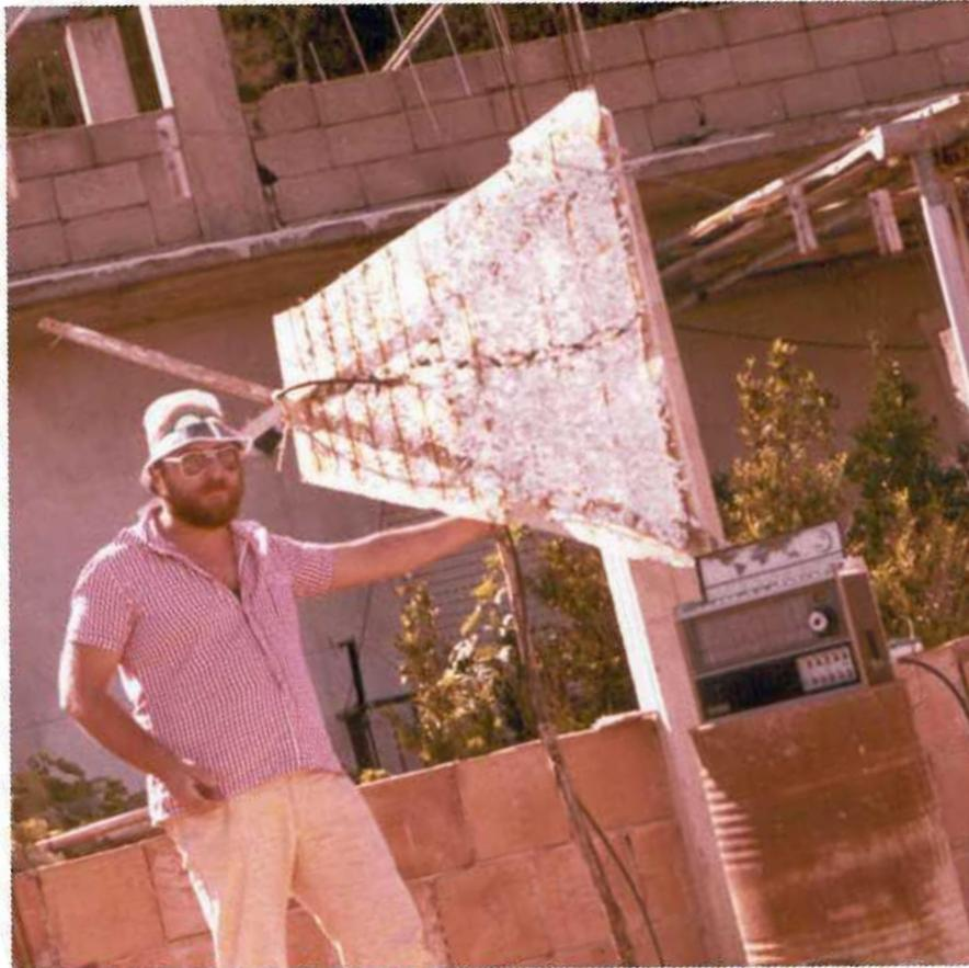
ISØIEK nel 1981 con un'antenna sperimentale log periodica, immersa in dielettrico solido artificiale.
